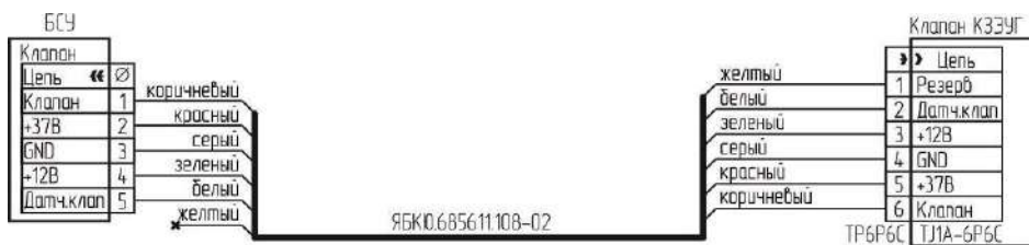
Рисунок Б.5 – Схема подключения клапана К3ЭУГ с разъемом TJ1A-6P6C.
