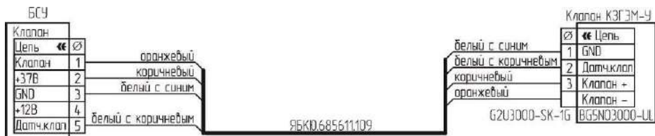
Рисунок Б.4 – Схема подключения клапана К3ГЭМ-У с разъемом BG5NO3000-UL.
